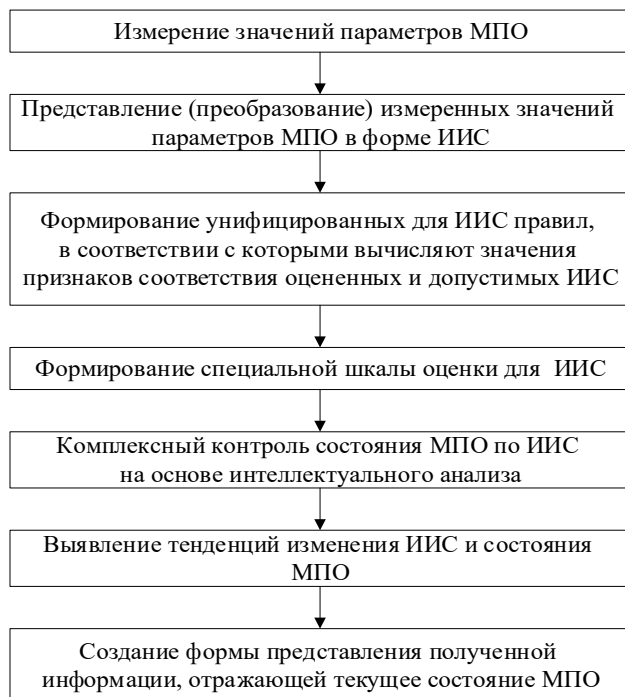
Рис. 2. Алгоритм комплексного мониторинга состояния территориальной техносферы
